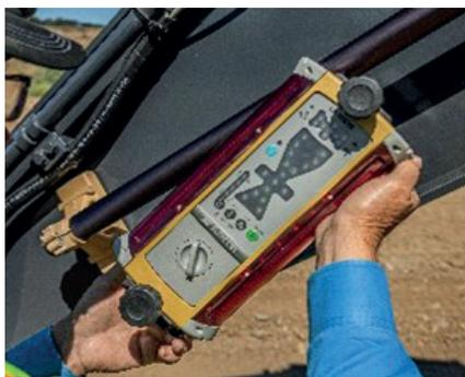
Le système de guidage 2D Topcon sur l'Easygrader est intuitif, simple d'utilisation et vous permettra de gagner en productivité et en précision. Il est également évolutif 3D.
